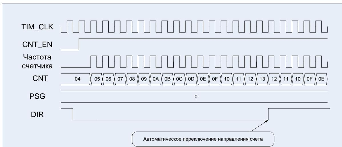
Рисунок 48 – Диаграммы работы таймера, счет двунаправленный, сначала прямой
